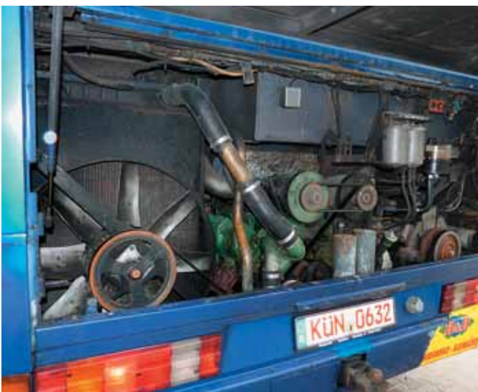
Im Heck arbeitet ein V-8-Triebwerk mit 14,6 l Hubraum und 370 kW (503 PS). Zur Bordstromerzeugung dienen zwei Lichtmaschinen, rechts ist außerdem ein relativ großvolumiger Klimakompressor zu sehen.
