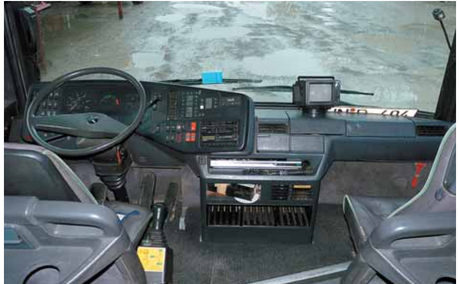
Der Fahrerplatz im Doppeldecker war weitgehend identisch mit dem der anderen Varianten des Mercedes-Benz O 404. Allerdings war beim Doppeldecker das EPS (erkennbar an dem Joystick-Schalthebel) Standard, während die Normalversionen in der Basisausstattung über eine manuelle Sechsgangschaltung verfügten.
