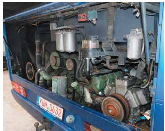
Im Heck arbeitet ein V-8-Triebwerk mit 14,6 l Hubraum und 370 kW (503 PS). Zur Bordstromerzeugung dienen zwei Lichtmaschinen, rechts ist außerdem ein relativ großvolumiger Klimakompressor zu sehen.
