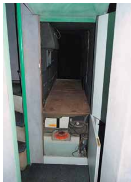
Der Mittelgang im Unterdeck mündet in der Fahrerschlafkabine. Links erkennt man den Anfang der Treppe zum Oberdeck, rechts (nicht sichtbar) befindet sich die Küche. Für diese wurden Wassertank und Batterien im Fahrerruherraum untergebracht.
