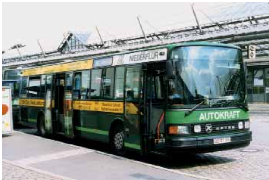
Beide Einstiege beim S 215 NR waren stufenlos. Die Einstiegshöhe betrug je nach Bereifung 340 mm oder 380 mm und konnte mit Hilfe des serienmäßigen Kneeling um 90 mm reduziert werden. Auf dem Foto ist Wagen 515 der Autokraft in Kiel zu sehen. Foto: Volkhard Stern
