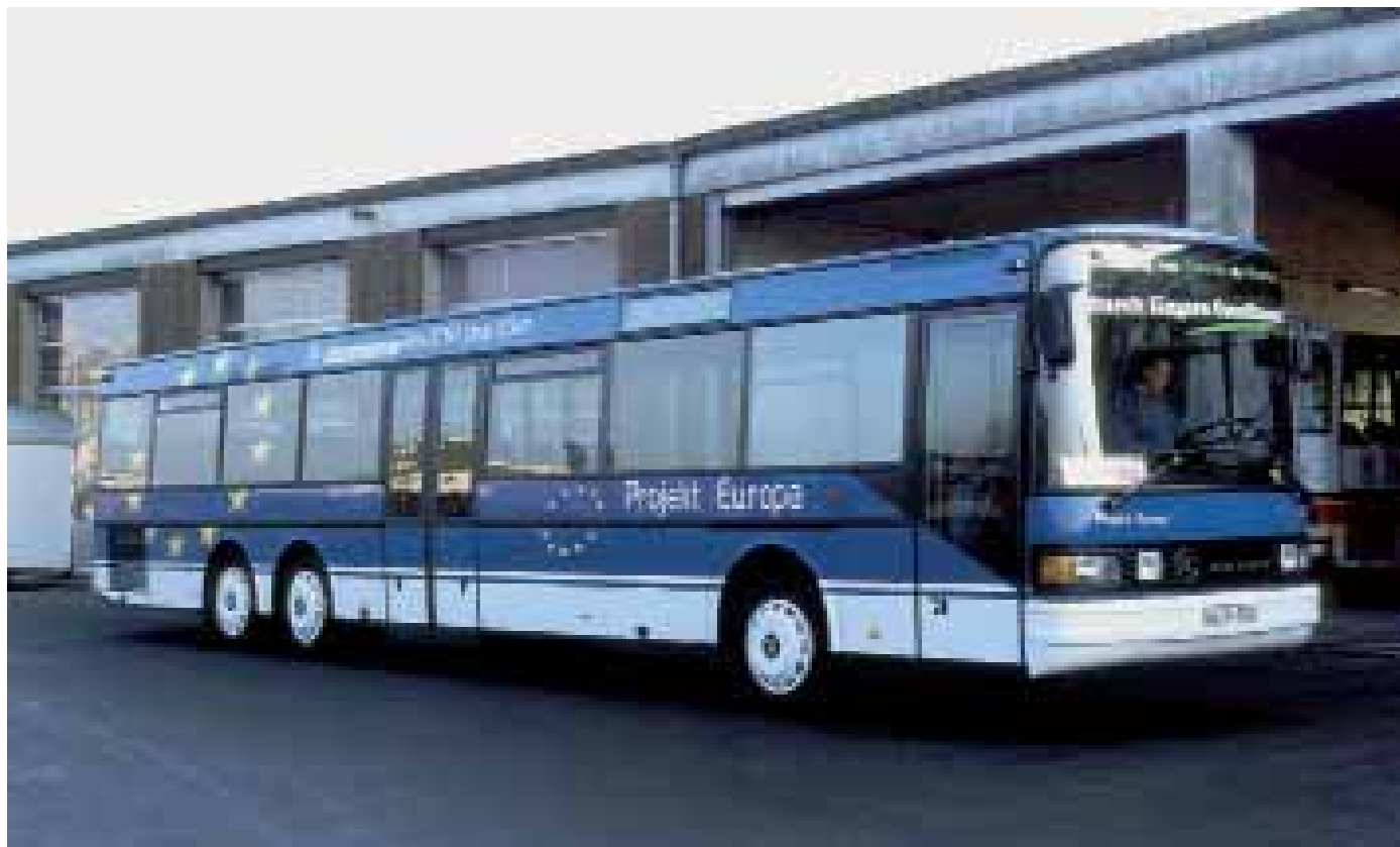
Den Setra S 217 NR leitete man aus dem 12-Meter-Modell ab, indem man zwischen Mittel­tür und Antriebsachse ein 1,34 m langes, zusätzliches Segment mit einem Fensterfeld und einer Vorlaufachse einfügte. Der Prototyp diente zunächst zu Vorführ- und Demonstrationszwecken. Foto: Ulrich Engelter
