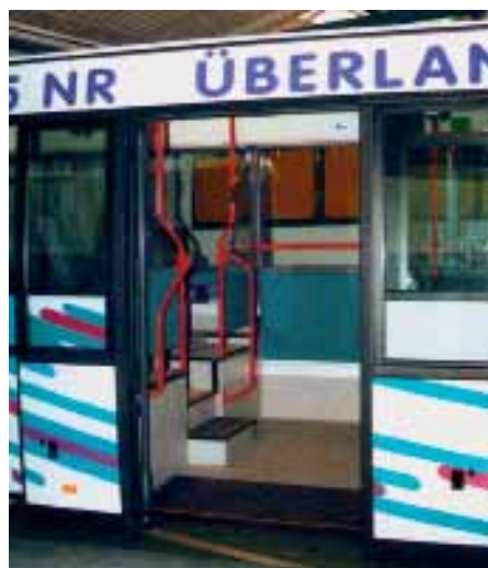
Wie heute war auch der Low Entry von 1992 bis zum Mitteleinstieg niederflurig, dort führten zwei Stufen in den erhöhten Fondbereich. Die erste Stufe ragte allerdings in die Plattform hinein und war insofern nicht ganz glücklich angeordnet. Fotos (2): Setra
