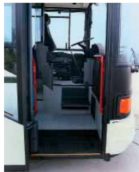
Der Fahrer saß wie im modernen Setra Low Entry auf dem Niveau des UL. Eine Klapptrittstufe ermöglichte dem Chauffeur einen bequemen Zugang zu seinem Arbeitsplatz. Die Gangwahl erforderte damals noch etwas mehr Kraft, wie der lange Schaltknüppel verdeutlicht.
