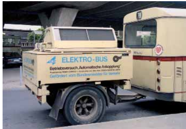
Beim Schnellladen am Bahnhof Benrath wurden die Akkus stark erwärmt, daher war dafür eine zusätzliche Kühlung der Batterien erforderlich, erkennbar an dem neuen Aufsatz. < Foto: Ulrich Engelter
