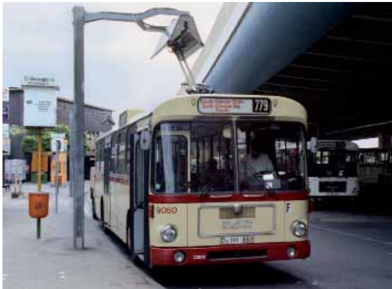
1982 wurden am Bahnhof Benrath Ladeschienen installiert, an denen die MAN SL-E der Rheinbahn mittels Pantographen in den Pausen nachladen konnten; im Bild Wagen 9060. < Foto: Ulrich Engelter
