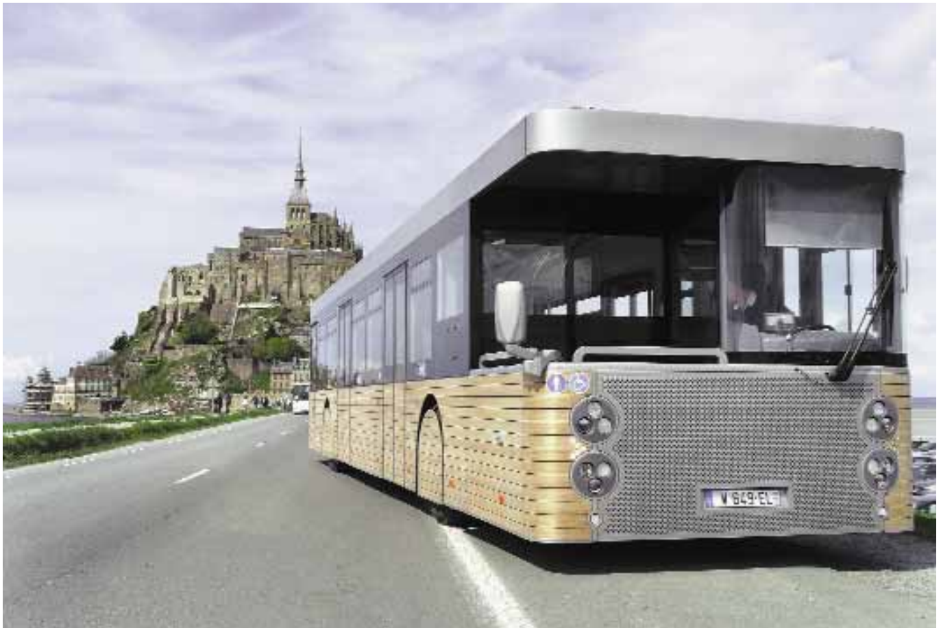
Für den Touristenverkehr zur berühmten Abtei Mont-Saint-Michel baut Contrac acht Spezialbusse des Typs Cobus DES, die an beiden Enden Führerstände aufweisen. Hier ist der A-Kopf zu sehen, an dem der Motor installiert ist. << Fotos: Contrac
