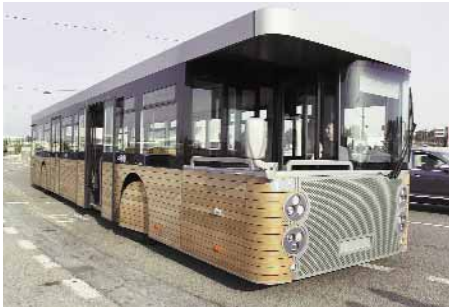
Am B-Kopf befindet sich ein begehbare Balkon an der Stelle, wo beim A-Kopf der Motor sitzt. Die Radabdeckungen sind auf den Rädern montiert und lenken daher mit.
