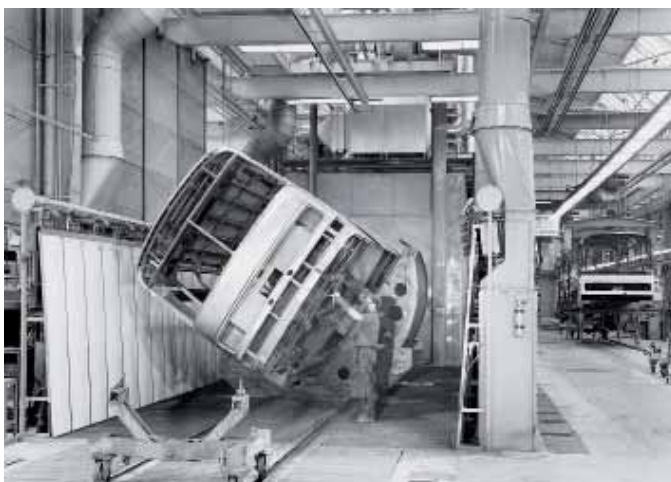
Auf einer drehbaren Schwenkvorrichtung wurde der gesamte Unterbau mit Einbrenngrundierung gespritzt. Eine gleichartige Schwenkvorrichtung diente zum Auftragen einer 1 mm bis 2 mm dicken PVC-Schutzschicht auf der Bodenunterseite.
