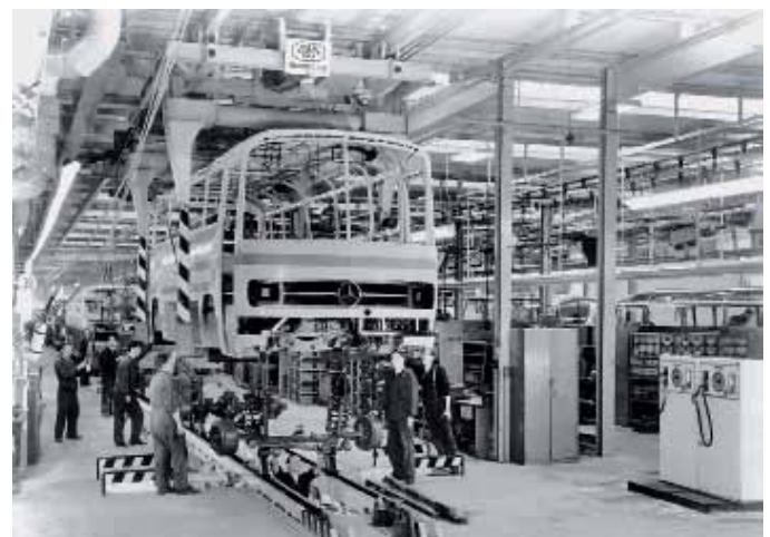
Die fertig lackierte und bereits mit elektrischen Leitungen versehene Karosserie wird hier auf die vorbereiteten Achsaggregate aufgesetzt.
