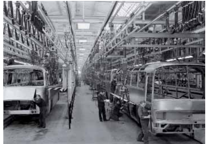
Am Rohmontageband wurde die Seitenbeplankung am Gerippe befestigt. Die Blechtafeln waren in den erforderlichen Abmessungen beschnitten. < Fotos (4): Daimler
