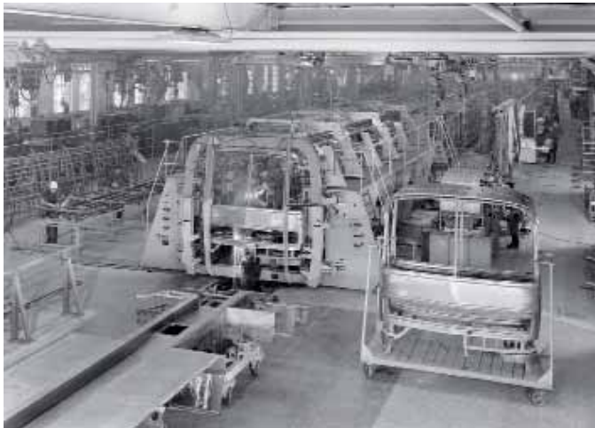
Vom prinzipiellen Aufbau erinnern die für den O 302 vollkommen neu gestalteten Fertigungsabläufe in Mannheim an Buswerke unserer Tage: In dieser Großbauvorrichtung wurden die Gerippegruppen für Unterbau, Seitenteile, Heck, Vorbau und Dach zusammenschweißt.
