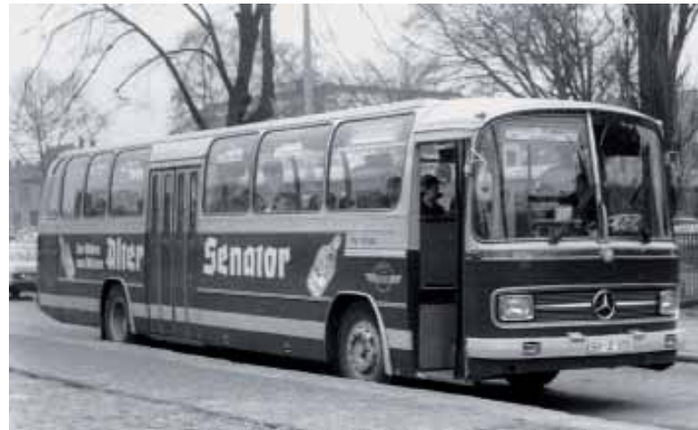
Die beiden Falttüren und die niedrige Kofferraumlinie würden Wagen 25 der Delmenhorst-Harpstedter Eisenbahn eigentlich als lupenreinen Linienbus ausweisen - wäre da nicht die Reisebusfront. Der O 302-13 RÜnh wurde 1972 gebaut. < Foto: Hanke
