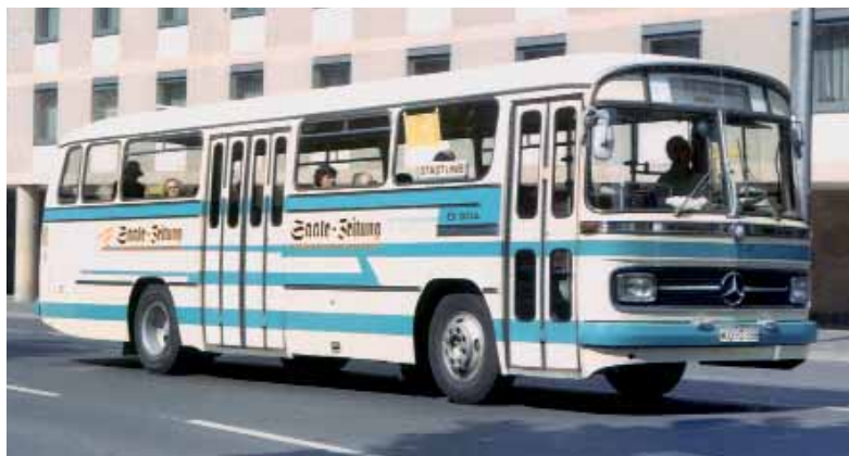
Wenn man sich anstelle der Mitteltür ein Fenstersegment denkt, entspricht dieser 0 302-11 RÜn hinsichtlich des Fensterteilers dem links abgebildeten Reisewagen. Ungewöhnlich bei diesem Linienbus der Firma Weltz aus Bad Kissingen ist die Anbringung des seitlichen Zielschilds im Fenster. < Foto: Dirk Sombrutzki
