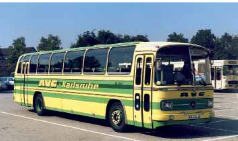
Bei den 0 302-13 RÜh für den Reiseverkehr waren die drei vorderen Seitenscheiben gleich lang (gemessen an der Oberkante), bis zur Hecktür folgten dann noch zwei mittellange und eine kurze. Wagen 137 der Albtalbahn wurde 1973 in Dienst gestellt.
