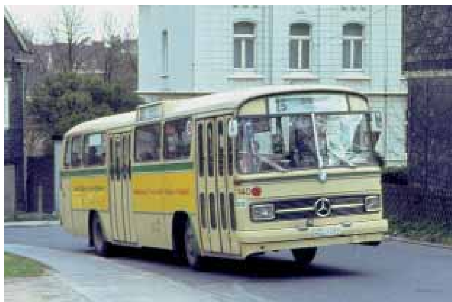
Nicht sehr verbreitet war die Version mit Doppelspureinstieg, obwohl sie im Einmannverkehr durchaus ihre Vorteile hatte: Rechts stiegen Barzahler ein; während sie abgefertigt wurden, konnten Sichtkarteninhaber links an ihnen vorbeigehen. Einer der wenigen Betriebe, die O 302 mit zwei Doppeltüren einsetzten, waren die Stadtwerke Solingen; im Bild Wagen 140, ein O 302-11 RStnD vom Baujahr 1967; das Pendant mit hohen Seitenscheiben haben wir auf Seite 54 abgebildet. < Foto: Peter Hanses
