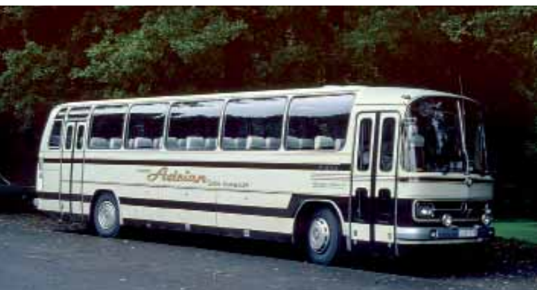
Die Reiseausführung des 0 302-12 RÜh besaß zwischen den beiden Türen drei lange und zwei kurze Scheiben, hier ein Fahrzeug der Firma Heinrich Adrian aus Lünen.
