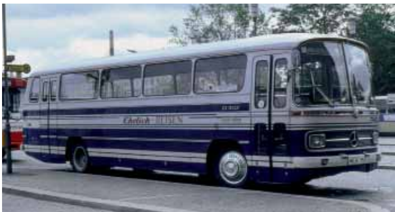
Bei 10- und 11-Reiher war der Fensterteiler von Reise- und Linienbussen gleich, weil sich vor der Hinterachse ohnehin ein Fenstersegment mit passender Größe für eine Mitteltür befand. Der abgebildete 0 302-11 RÜn war bei der Firma Ehrlich in Großheubach im Einsatz. < Foto: Bleck/Sammlung Schneider
