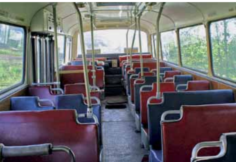
Die 1967 gelieferten O 302-11 RStn der Hamburger Hochbahn (siehe Seite 54) boten bei einer Gesamtlänge von 10,15 m 32 Sitz- und 58 Stehplätze. Der Fahrerplatz mit dem großen, einfachen Lenkrad ist im Vergleich zu heutigen Cockpits sehr übersichtlich. Die Fotos wurden im ehemaligen Hochbahn-Wagen 6789 gemacht, der sich heute in der Obhut des Hamburger Omnibusvereins (HOV) befindet. < Fotos (2): Stephan Günther
