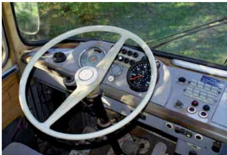
Die 1967 gelieferten O 302-11 RStn der Hamburger Hochbahn (siehe Seite 54) boten bei einer Gesamtlänge von 10,15 m 32 Sitz- und 58 Stehplätze. Der Fahrerplatz mit dem großen, einfachen Lenkrad ist im Vergleich zu heutigen Cockpits sehr übersichtlich. Die Fotos wurden im ehemaligen Hochbahn-Wagen 6789 gemacht, der sich heute in der Obhut des Hamburger Omnibusvereins (HOV) befindet. < Fotos (2): Stephan Günther
