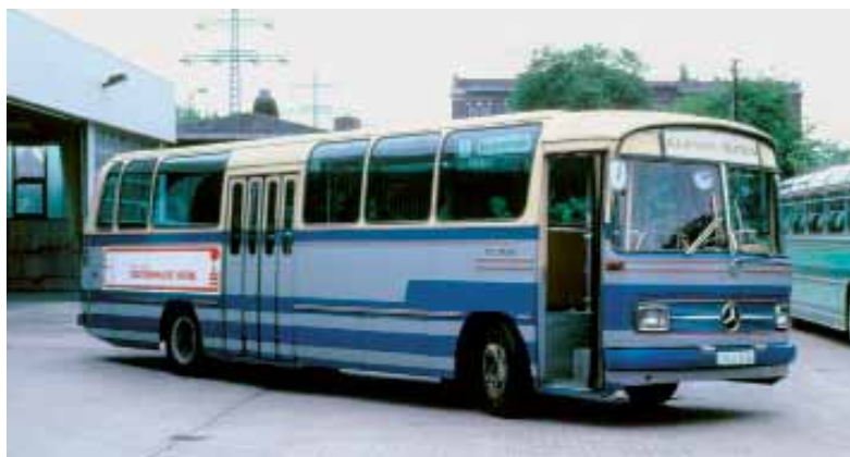
Bei der Linienversion des 12-Reiher befanden sich drei Scheiben zwischen Vorder- und Mitteltür, von denen zweite und dritte kürzer waren als beim Reisebus, während Türsegment und Folgescheibe entsprechend länger ausgeführt waren. Der abgebildete 0 302-12 RStnh gehörte der Firma Alewa in Werne.
