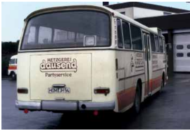
Bei der Heckgestaltung gab es praktisch keine Unterschiede zwischen Linien- und Reisewagen, die Liniennummernanzeige war in der Rückscheibe untergebracht. Bei diesem Fahrzeug der Hüther & Junkes GmbH irritiert die Zierleiste ein wenig, es handelt sich um einen O 302-12 Stn. < Foto: Norbert Prinz
