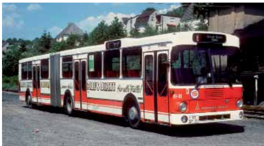
Wagen 81-31 des Regionalverkehr Ruhr-Lippe verkörpert die Ausführung mit glatter Beblechung, aber noch dem alten Markenschriftzug auf der Front.
