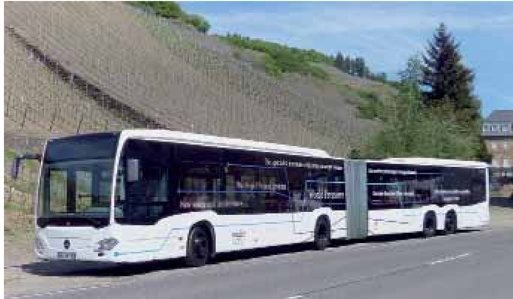
Der Testbus ist mit einem Metrodesign-Paket ausgestattet. Hinter der verlängerten Dachverkleidung befindet sich die Klimaanlage.
