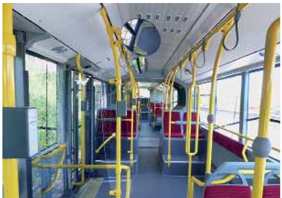
Der Innenraum weist große Stehflächen auf. Unser Testbus verfügt über nur 37 Sitzplätze.
