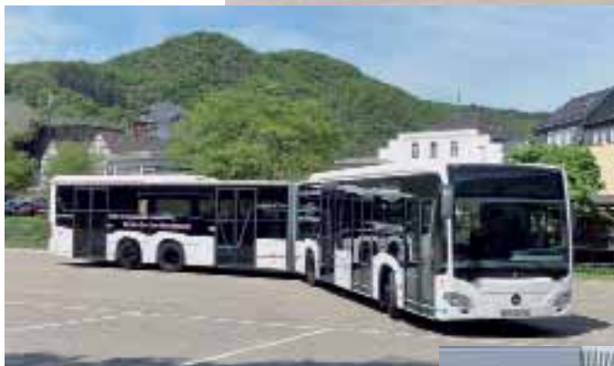
Hier haben wir den Capacity L einmal im maximalen Knickwinkel von 51,4 Grad positioniert. Schön zu erkennen ist das eingelenkte hintere Rad. Die Zeichnung bietet die theoretische Veranschaulichung.
