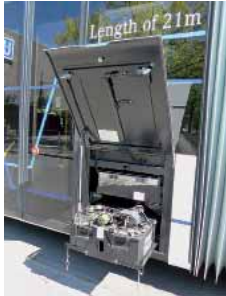
Rechts hinter dem Gelenk sind die separaten Starterbatterien untergebracht. Darüber befindet sich beim Capacity L das Rekuperationsmodul.
