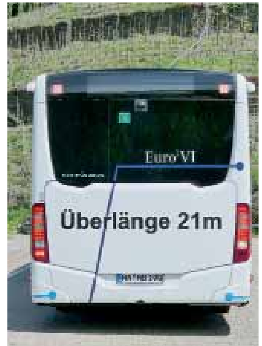
Ein Warnhinweis auf dem Heck informiert andere Autofahrer über die Überlänge des Capacity L. Kameras am Heck unterstützen den Fahrer beim Manövrieren in engen Kurven sowie beim Rückwärtssetzen.
