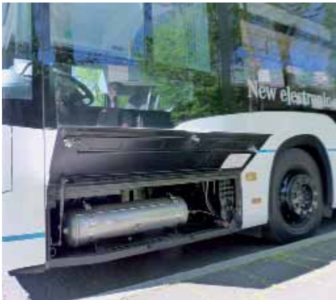
Unter dem Fahrerplatz befinden sich beim Capacity L Druckluftkessel. Beim Citaro ist dort das Rekuperationsmodul verbaut.
