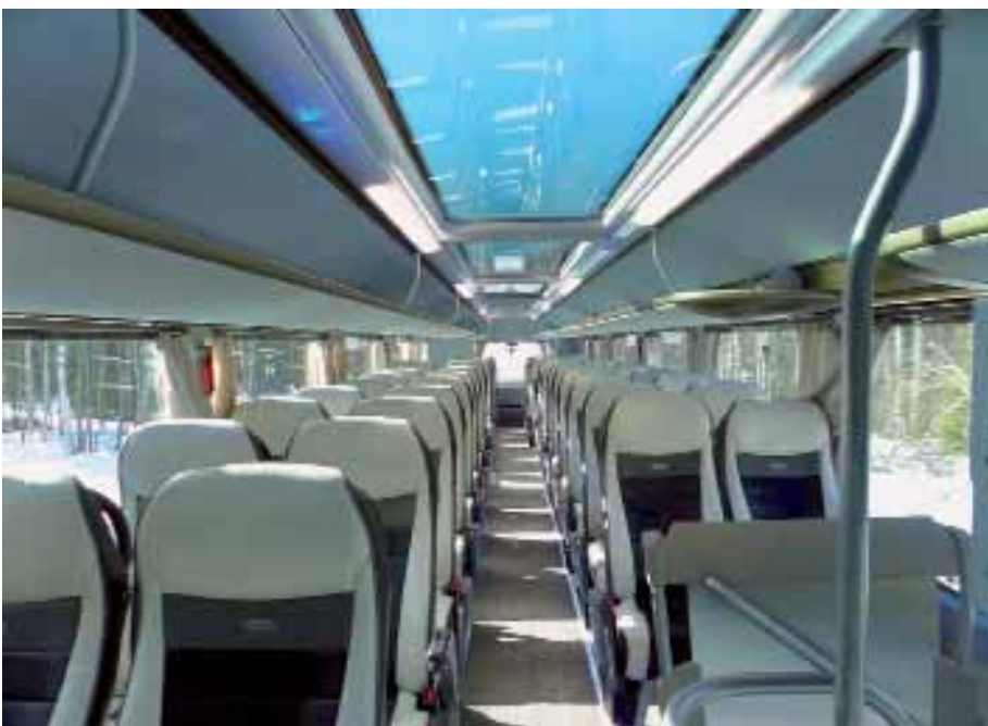
Hell und freundlich eingerichtet ist das Oberdeck. Das Glasdach erstreckt sich über die gesamte Länge des Fahrzeugs.
