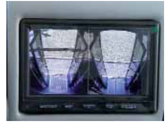
Gut einsehbar ist der Bildschirm, der sowohl die Aufnahmen der Kameras an den Einstiegen als auch das Bild der Rückfahrkamera wiedergibt.
