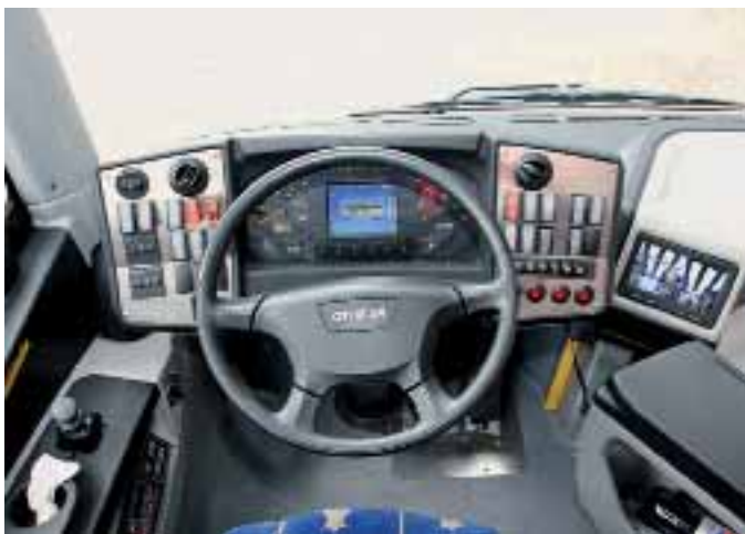
Der Fahrerarbeitsplatz mit Aktia-Display ist übersichtlich gestaltet. Ein Knebel an der Lenksäule dient zur Lenkradverstellung.
