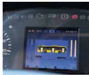
Gut einsehbar ist der Bildschirm, der sowohl die Aufnahmen der Kameras an den Einstiegen als auch das Bild der Rückfahrkamera wiedergibt.
