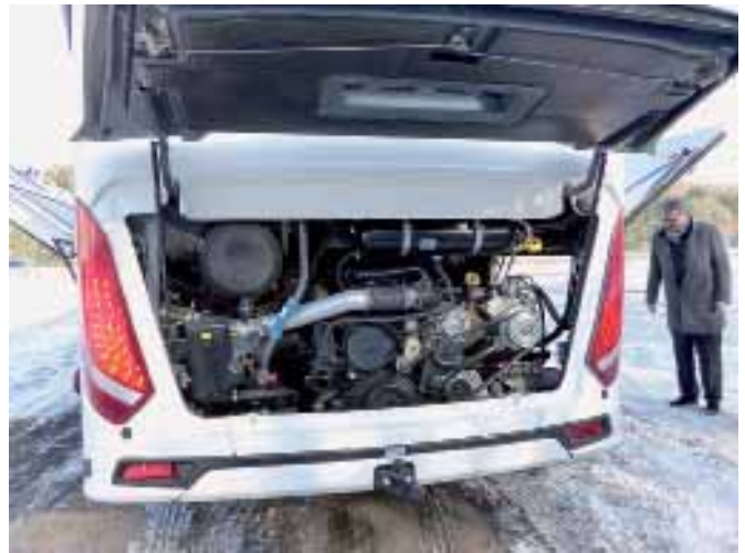
Ausgestattet ist der Scania Interlink HD 14 m mit dem 12,7-Liter-Dieselmotor DC 13 124. Er hat eine Leistung von 331 kW (450 PS) und 2.350 Nm Drehmoment. Eine Brandlöschanlage ist Option.
