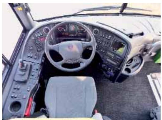
Der altbewährte Scania-Fahrerarbeitsplatz. Digitacho, CD-Player und Klimaregelung sind auch während der Fahrt gut erreichbar. Manchmal ein Fahrer bemängelt die vielen Schalter.
