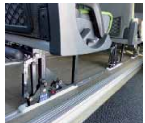
Für zwei Rollstühle werden sechs Doppelsitze auf Airlineschienen zusammengesoben. Vorher löst man die Schnellverschlüsse.
