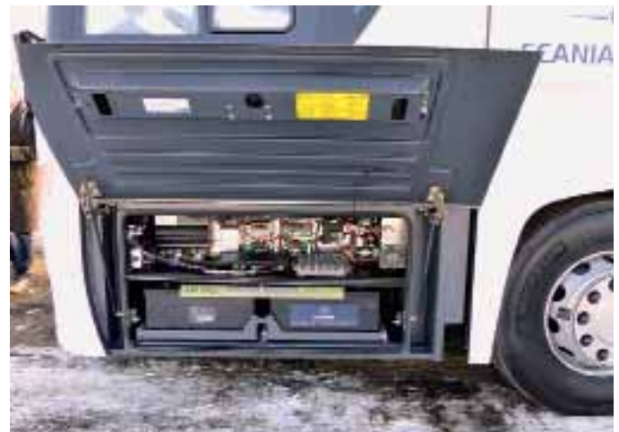
Elektrik und Batterien sind vorne links im crashgefährdeten Bereich angeordnet. Die Batterien lassen sich auf einem Schlitten herausziehen.
