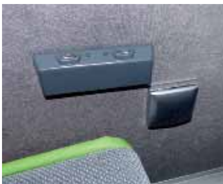
Pro Doppelsitz gibt es eine 230-Volt-Steckdose und zwei USB-Anschlüsse.
