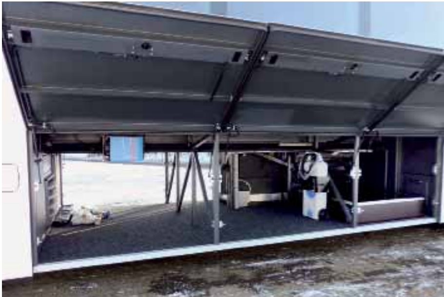
Im Kofferraum ist mit 11,79 m 3 jede Menge Platz für Gepäck vorhanden. Rechts sieht man die Liftkassette, links den Spannungswandler für die 230-Volt-Steckdosen an den Sitzplätzen.
