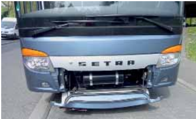
Der Bauraum für das Ersatzrad wurde auf Grund der geringen Platzverhältnisse für den Druckluftkessel (Nebenaggregate) benötigt.
