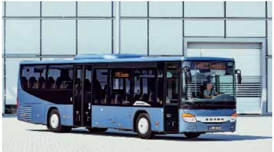
Drei Türbreiten stehen zur Wahl. Bei 1.380 mm Breite ist die Mitteltür zweiflügelig ausgeführt.
