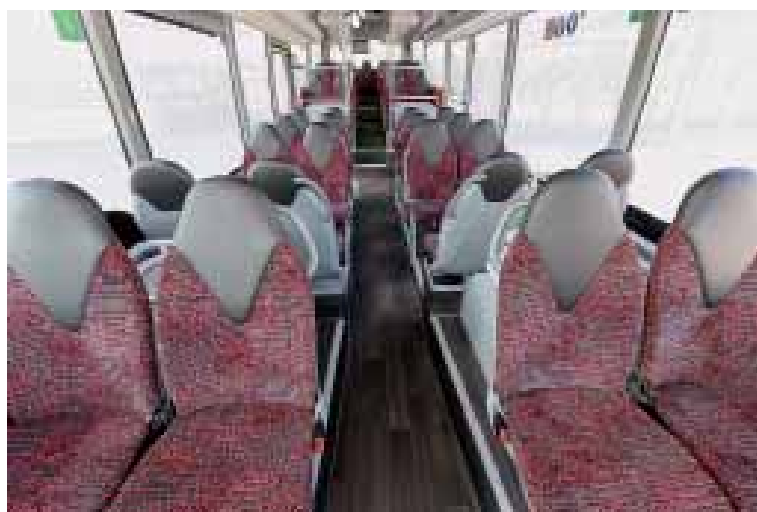
Bewusst einfach gehalten ist der Innenraum. Im Niederflurbereich zwischen den Türen eins und zwei sind die Sitze auf Podesten angeordnet. Grob gelochte Gepäckablagen durchbrechen optisch die große Stehhöhe von 2.620 mm. < Foto: Daimler
