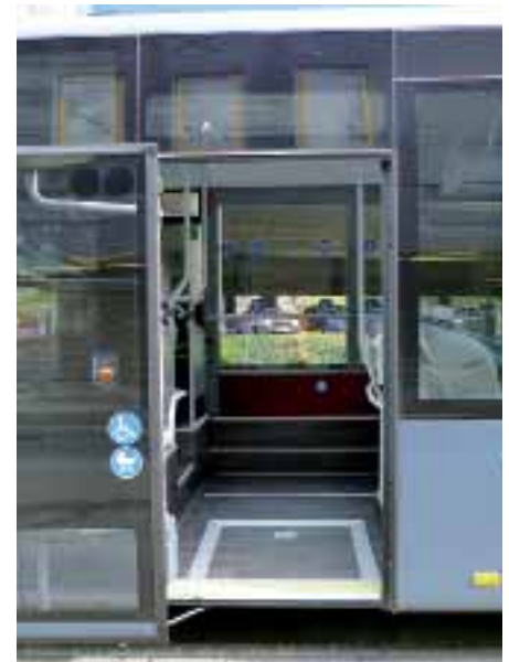
Der 1.150 mm breite Mitteleinstieg ist mit einer einflügeligen Außenschwingtür versehen. Im Inneren gelangt der Fahrgast hier zum Mittelperron.
