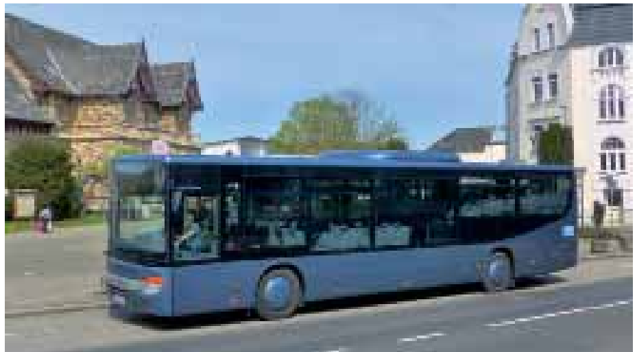
Fensterseitig ist der Versatz zum UL-Heck gut zu erkennen. Optisch kaschiert wurde er mit einem geschwärtztem Farbkeil, der eine gleichhohe Fensterunterkante suggeriert.
