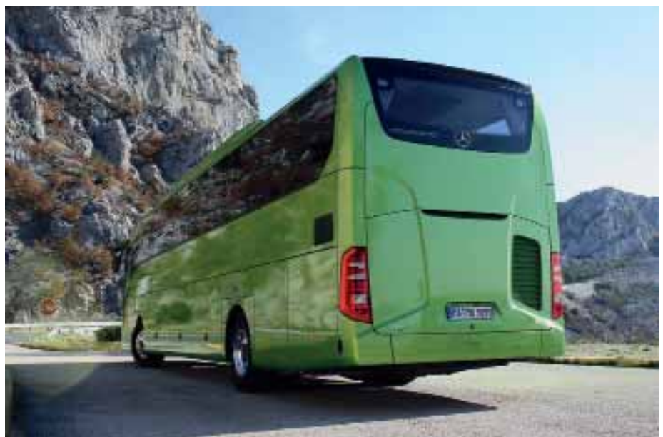
Das Heck zeichnet sich durch eine umlaufende Abrisskante aus, die Luftverwirbelungen direkt hinter dem Fahrzeug vermeiden soll. Die trapezförmige Heckscheibe geht glatt in den Dachbereich über.
