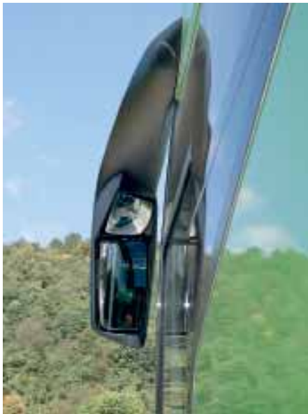
Die eng am Wagenkörper angeordneten Außenspiegel erhielten eine aerodynamische Form.
