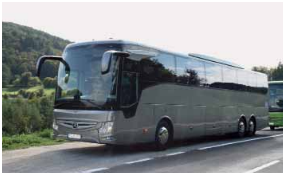
Der dreiachsige Tourismo L verfügt bei 13.935 mm Gesamtlänge über den gleichen Abstand zwischen erster und zweiter Achse wie der 13-Meter-Zweiachser.
