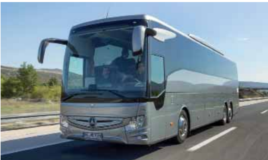
Ebenfalls 13.115 mm misst der Tourismo M/3, der mit drei Achsen vorfährt. Sein Radstand zwischen erster und zweiter Achse beträgt 6.090 mm.
