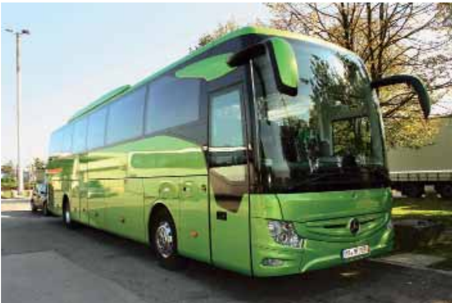
Der Tourismo M/2 misst 13.115 mm bei einem Radstand von 6.910 mm. Bei einem zulässigen Gesamtgewicht von 19,5 t kommt er problemlos mit zwei Achsen aus.
