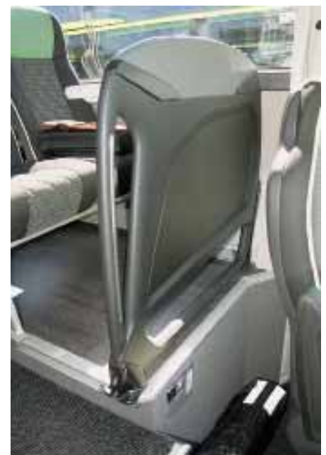
Die Prallwand vor der ersten Sitzreihe gibt es in verschiedenen Ausführungen: Rechts so, wie sie von Mercedes-Benz kommt, links, wie sie die Gütegemeinschaft Buskomfort (GBK) vorschlägt.
