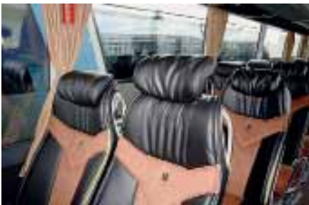
Die Sitze sind in unterschiedlichen Ausführungen lieferbar: Links die neue Softline-Bestuhlung, rechts die hochwertigen Reisebussitze mit verstellbarer Kopfstütze.
