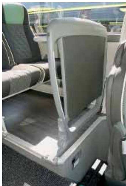
Die Prallwand vor der ersten Sitzreihe gibt es in verschiedenen Ausführungen: Rechts so, wie sie von Mercedes-Benz kommt, links, wie sie die Gütegemeinschaft Buskomfort (GBK) vorschlägt.
