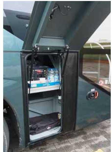
Das Nachschubfach vorne rechts, in dem der Fahrer diverse Utensilien lagern kann, ist bei offener Einstiegsstür nicht mehr zugänglich. Für diesen Fall gibt es eine Klappe im Vordereinstieg.
